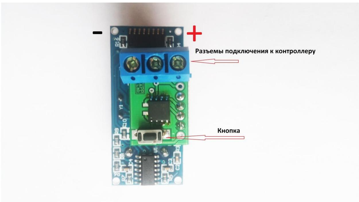
Настройка происходит следующим образом: нажатием кнопки вы прибавляете к дальности срабатывания датчика по 10 см. Диапазон от 10см. до 2м. По достижению максимальной дальности настройка сбрасывается на минимум и цикл повторяется.
